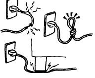
Nemojte grepsti, oštećivati ili vršiti izmjene na kabelima za napajanje. Također nemojte stavljati teške predmete na uređaj, povlačiti ili prejako savijati kabele za napajanje jer biste time mogli izazvati **požar ili strujni udar**.
