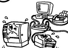
Ako je uređaj uključen u istu električnu utičnicu s drugim uređajima koji troše velike količine energije, doći će do velikih fluktacija napona uvijek prilikom rada tih uređaja. Svakako osigurajte zasebnu utičnicu za uređaj jer biste mogli izazvati **požar ili strujni udar**.
