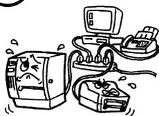
Si la machine partage une même prise avec d'autres appareils consommant beaucoup d'électricité, il y aura des fluctuations de tension importantes lorsque ces appareils fonctionnent. Pour éviter tout risque d'**incendie** ou de **décharge électrique**, ne branchez pas d'autres appareils à la même prise que la machine.
