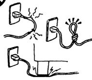
No roce, dañe ni modifique los cables de alimentación. Además, no coloque objetos pesados sobre los cables, no tire de ellos ni los doble excesivamente, ya que se podrían producir **incendios** o **descargas eléctricas**.
