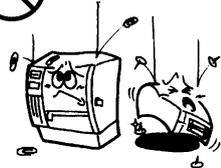
Achten Sie darauf, dass keine Metallgegenstände, brennbare Materialien oder sonstige Fremdkörper in die Ventilationsöffnungen des Druckers gelangen, ansonsten kann **Feuer** oder ein **elektrischer Schlag** verursacht werden.
