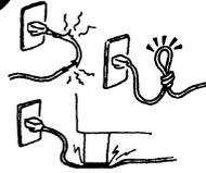
Não arranhe, danifique ou modifique os fios elétricos. Além disso, não coloque objectos pesados em cima dos fios elétricos, nem puxe ou dobre excessivamente os fios elétricos uma vez que isto poderá causar **incêndios** ou um perigo de **choques elétricos**.
