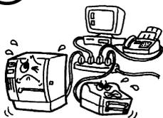
Se o equipamento partilhar a mesma tomada com qualquer outro equipamento elétrico que consuma uma grande quantidade de eletricidade, a tensão flutuará sempre que estes equipamentos forem utilizados. Certifique-se de que utiliza uma tomada exclusivamente para o equipamento, evitando com isto riscos de **incêndio** ou **choque elétrico**.
