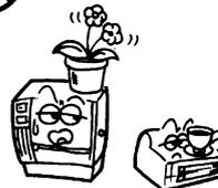
Não coloque objectos de metal ou recipientes com água, por exemplo, vasos com flores, panelas ou copos, etc., em cima do equipamento. Se os objectos de metal ou os líquidos derramados entrarem no equipamento, podem provocar **incêndios** ou **choques elétricos**.
