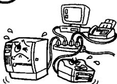
Falls der Drucker die Stromquelle mit anderen Elektrogeräten teilt, kann es zu Spannungsschwankungen kommen, wenn diese Geräte in Betrieb genommen werden. Schließen Sie den Drucker möglichst an einen separaten Stromkreis an, um einen **Kurzschluss** oder **Überlastungen** zu vermeiden.
