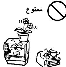
إذا كان الجهاز يشترك في نفس منفذ التيار الكهربائي مع أي جهاز آخر يستهلك قدرًا كبيرًا من الطاقة، فسوف يتقلب التيار الكهربائي على نطاق واسع في كل مرة تعمل فيها هذه الأجهزة. وتأكد من توفير منفذ خاص للجهاز حيث أن ذلك قد يتسبب في نشوب حريق أو حدوث صدمة كهربائية.
