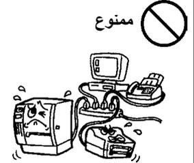
لا تقم بخدش أو إتلاف أو تعديل أسلاك الطاقة. كما يُرجى عدم وضع أشياء ثقيلة على أسلاك الطاقة أو شدّها أو ثنيها بشكل مفرط، لأن ذلك قد يتسبب في نشوب حريق أو صدمة كهربائية.
