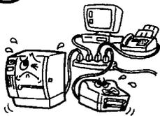
Si la máquina comparte la misma toma con otros aparatos eléctricos que consumen gran cantidad de energía, la tensión fluctuará considerablemente cada vez que funcionen estos aparatos. Utilice una toma exclusiva para la máquina; no hacerlo podría ocasionar **incendios** o **descargas eléctricas**.
