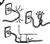
No roce, dañe ni modifique los cables de alimentación. Además, no coloque objetos pesados sobre los cables, no tire de ellos ni los doble excesivamente, ya que se podrían producir **incendios** o **descargas eléctricas**.
