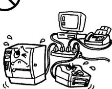
Если аппарат подключен к розетке, к которой уже подключено несколько приборов большой мощности, то при каждом включении таких устройств в сети возможны значительные перепады напряжения. Во избежание **пожара** или **поражения электрическим током** убедитесь, что аппарат подключен к выделенной розетке.
