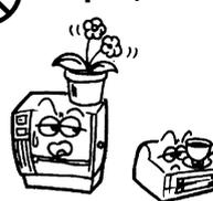
Не кладите металлические предметы или сосуды с водой, например, цветочные вазы, цветочные горшки или кружки и т.п. на верхней части аппарата. Если металлические предметы или разлитая жидкость попадет внутрь аппарата, это может привести к **пожару** или **поражению электрическим током**.
