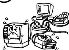
Se la macchina è collegata a una presa condivisa con altre apparecchiature elettriche ad elevato consumo energetico, potrebbero verificarsi fluttuazioni di tensione ogni volta che queste apparecchiature entrano in funzione. Collegare l'unità a una presa dedicata. In caso contrario, potrebbero verificarsi **incendi** o **shock elettrici**.
