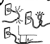
Das Stromkabel darf weder verkratzt noch beschädigt sein. Außerdem darf es nicht durch schwere Gegenstände belastet, überdehnt oder geknickt sein, da dies zu **Feuer** oder einem **elektrischen Schlag** führen kann.
