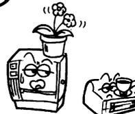
Stellen Sie keine Metallgegenstände oder mit Wasser gefüllte Behälter, wie z.B. Blumenvasen, Blumentöpfe, Becher usw., auf den Drucker. Falls Metallgegenstände oder verschüttete Flüssigkeiten in die Maschinen gelangen, besteht die Gefahr von **Feuer** oder einem **elektrischen Schlag**.
