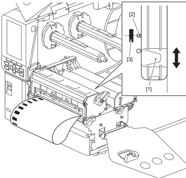
**■ Réglage du capteur de détection de fin de support**
