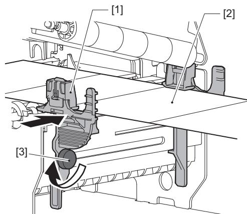
**11 提起锁定卡扣[1]并移动纸张宽度检测导板[2]，与纸张边缘对齐。**
