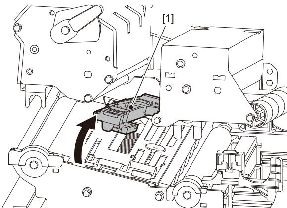
**5 松开外部纸张导板左右两侧上的翼形螺钉[1]，使其稍宽于纸张的宽度。**
