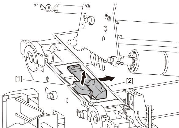
**12 向下按锁定卡扣[1]，锁定纸张宽度检测导板。**
