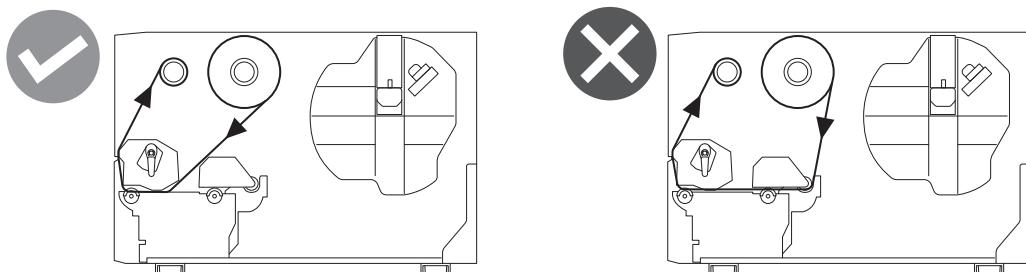
**7 放下打印头块[1]并设置色带轴固定板[2]。**
