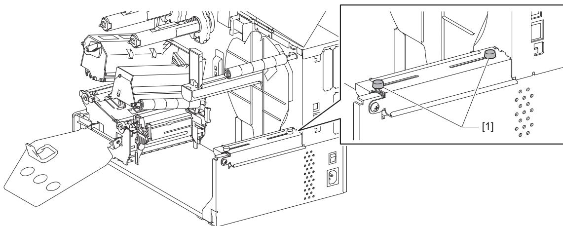
**6 在打印机后部放置扇形折叠纸[1]并将其末端插入外部纸张导板[2]下部的纸张槽口中。**
