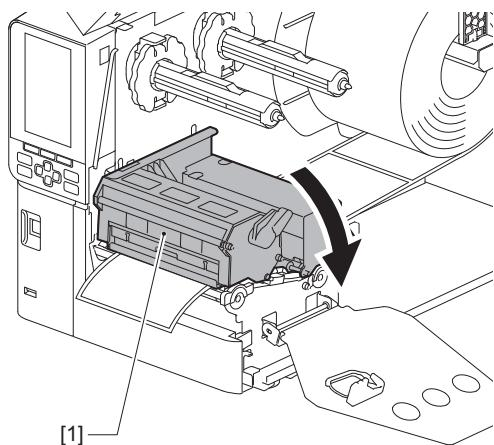
**6 设置色带轴固定板[1]并转动打印头卡扣[2]到“LABEL2”的位置，固定打印头块。**
