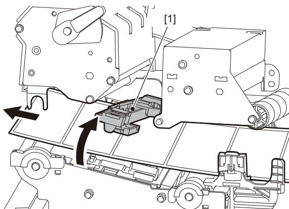
**11 将纸张导板[1]与纸张[2]之间的间隙调整到约0.5 mm (0.02") 的范围，并上紧翼形螺钉[3]固定纸张导板。**
