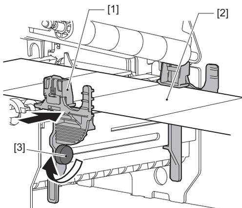
**11** Levante a alavanca de bloqueio [1] e mova a guia de detecção da largura do suporte [2] para a alinhar com a extremidade do suporte.
