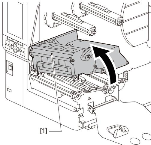
**5 Limpe o sensor de detecção de papel [1] e o sensor de fim de fita [2] com um pano macio que contenha uma pequena quantidade de etanol anidro ou com um cotonete.**
