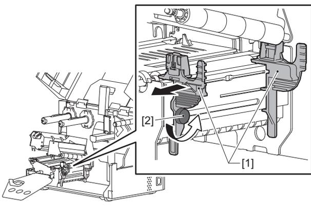
**9 Passe a margem superior do papel [1] entre os guias esquerdo e direito do papel [2] e alimente-o para a saída do papel através do lado inferior do bloco das cabeças de impressão.**
