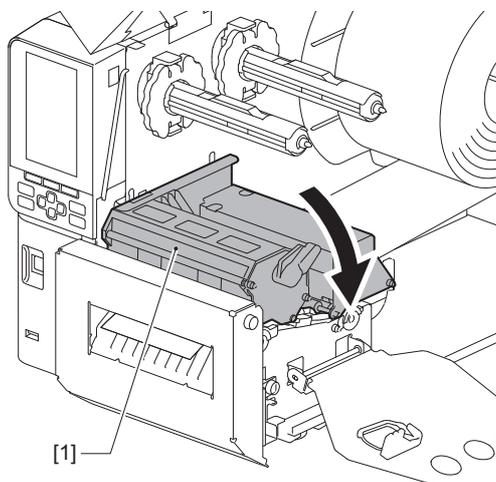
**4 Coloque a placa de fixação do eixo da fita [1] e rode a alavanca das cabeças [2] para a posição “LABEL2”, para fixar o bloco das cabeças de impressão.**
