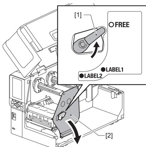
**4 Levante o bloco das cabeças de impressão [1] e remova o papel ou a fita.**
