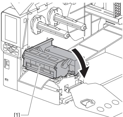
**11 Ρυθμίστε την πλάκα στερέωσης του άξονα της ταινίας [1] και ασφαλίστε το μπλοκ της κεφαλής εκτυπωσης περιστρέφοντας τον μοχλό κεφαλής [2] στη θέση «LABEL» ή «TAG», ανάλογα με τον τύπο του χαρτιού.**
