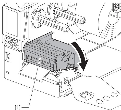
**6 Τοποθετήστε την πλάκα στερέωσης του άξονα ταινίας [1] και, στη συνέχεια, στρέψτε τον μοχλό κεφαλής [2] στη θέση «LABEL» ή «TAG» για να ασφαλίσετε το μπλοκ κεφαλής εκτύπωσης, ανάλογα με το χαρτί που χρησιμοποιείτε.**
