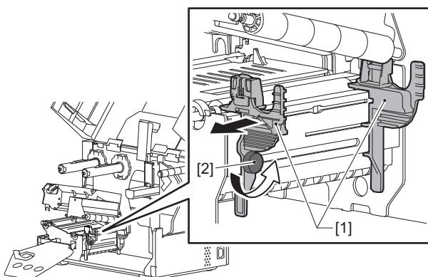
**9 Περάστε την μπροστινή άκρη του χαρτιού [1] μεταξύ του αριστερού και δεξιού οδηγού χαρτιού [2] και τροφοδοτήστε το στην έξοδο χαρτιού μέσω της κάτω πλευράς του μπλοκ κεφαλής εκτύπωσης.**
