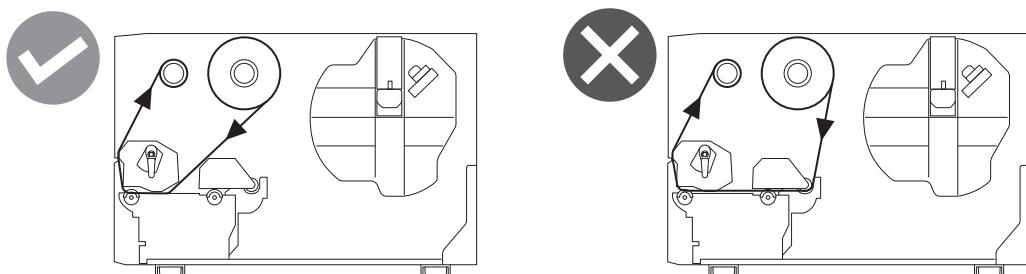
**7 Κατεβάστε το μπλοκ κεφαλής εκτύπωσης [1] και ρυθμίστε την πλάκα στερέωσης του άξονα της ταινίας [2].**
