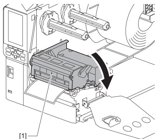
**12 Ρυθμίστε την πλάκα στερέωσης του άξονα της ταινίας [1] και ασφαλίστε το μπλοκ της κεφαλής εκτυπωσης περιστρέφοντας τον μοχλό κεφαλής [2] στη θέση «LABEL» ή «TAG», ανάλογα με τον τύπο του χαρτιού.**
