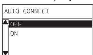
**9 Use o botão [FEED] ou [RESTART] para seleccionar [ON]/[OFF] para [CONEXÃO AUTOMÁT. (AUTO CONNECT)].**
