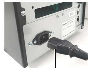
Cablu de alimentare
