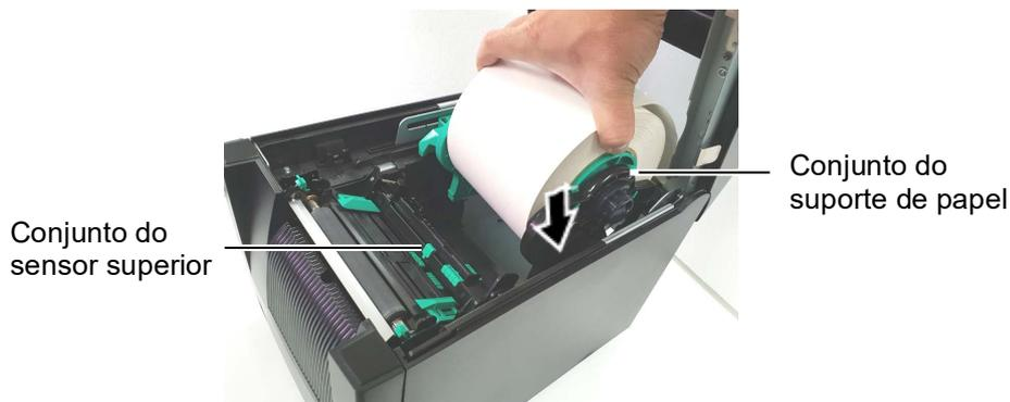
8. Empurre ligeiramente a alavanca do sensor superior para dentro (①) e abra o conjunto do sensor superior (②).
