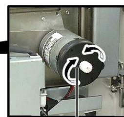
Eixo do motor do cortador
