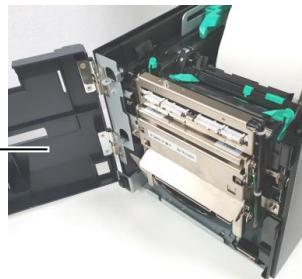
2. Pritisnite šipku za otpuštanje da biste otvorili modul za skidanje podloge.
