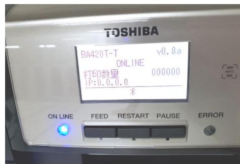
2. Provjerite je li se na LCD zaslonu za prikaz poruka pojavila poruka ON LINE i je li uključen LED indikator ON LINE (plavi).
