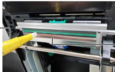
Elemento del cabezal de impresión
