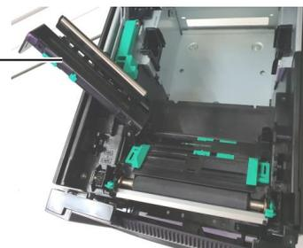
5. Retire el papel atascado de la impresora. **NO UTILICE** elementos cortantes o herramientas que puedan dañar la impresora.
