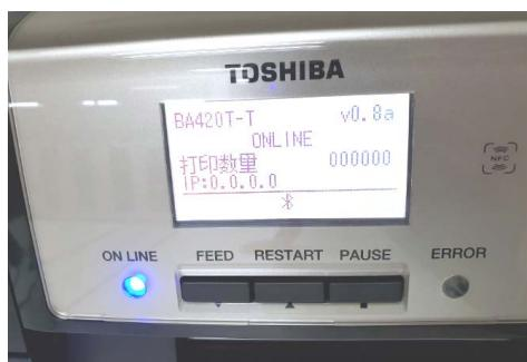
2. Zkontrolujte, že se na LCD obrazovce hlášení objevilo ON LINE a že LED ON LINE (modrá) svítí.
