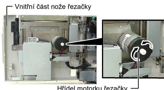
5. Stejným způsobem vyčistěte vnější část nože řezačky.
