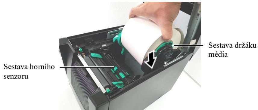
8. Jemně zatlačte páčku horního senzoru směrem dovnitř (①) a otevřete sestavu horního senzoru (②).
