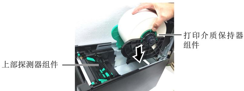
8. 轻轻向内推动上部探测器杆（①），打开上部探测器组件（②）。
