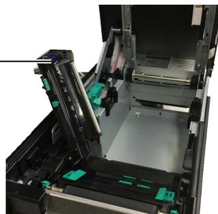
5. 清除打印介质通路上堵塞的打印介质。请不要使用任何可能损坏打印机的锐利器具或工具。
