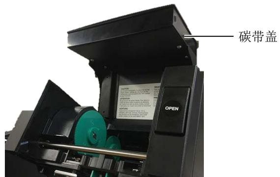
5. 将碳带提取芯装入碳带保持器（提取侧）内，使碳带芯的凹口与碳带限位器的突起吻合。
