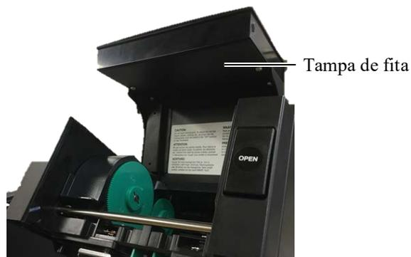
5. Coloque o núcleo de recolha da fita no suporte da fita (lado de recolha), alinhando o entalhe do núcleo da fita com a saliência do batente da fita.
