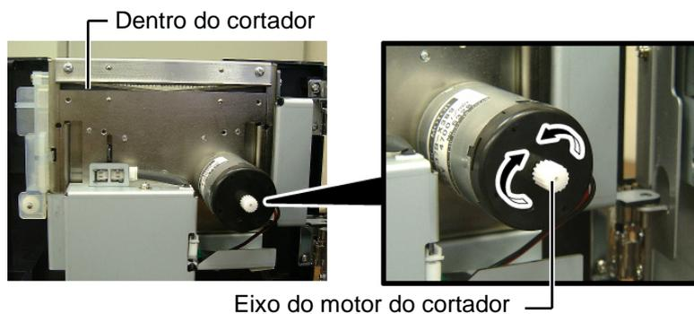
5. Da mesma forma, limpe a parte exterior da lâmina do cortador.
