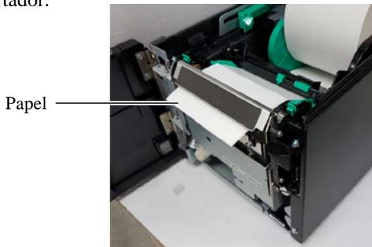
13. Altere a pressão da cabeça de impressão de acordo com a espessura do papel a usar usando a alavanca da posição da cabeça.
