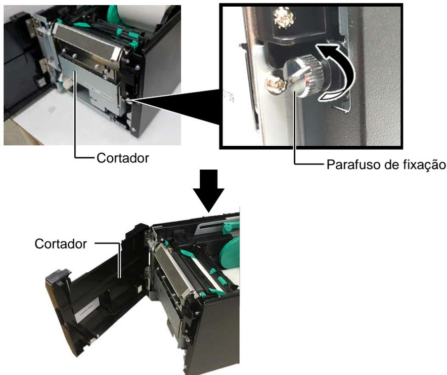
4. Limpe o interior da lâmina do cortador com um cotonete humedecido com álcool etílico. A lâmina de corte move-se para cima e para baixo quando o eixo do motor do cortador é rodado manualmente.
