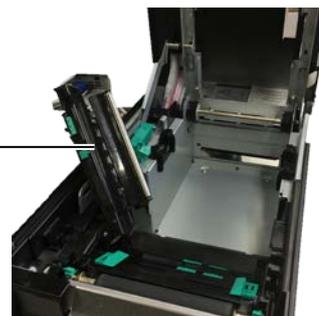
5. Remova o papel encravado da impressora. **NÃO UTILIZE** elementos cortantes ou ferramentas que possam danificar a impressora.
