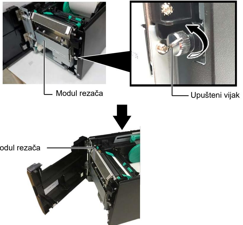
4. Očistite oštricu rezača iznutra štapićem malo navlaženim čistim etilnim alkoholom. Oštrica rezača kreće se gore-dolje kada se osovina motora rezača okreće rukom.
