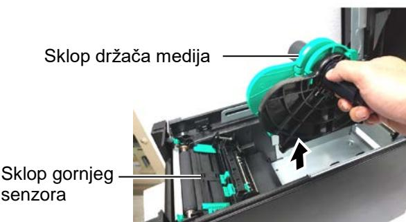
3. Podignite ručicu za otpuštanje i uklonite držač medija (lijevi).
