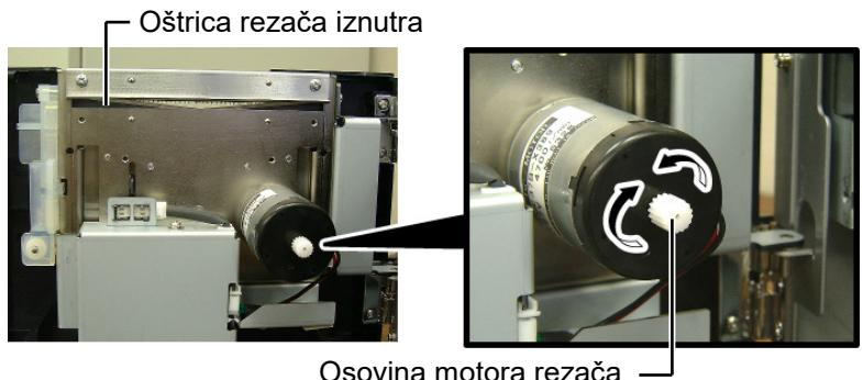
5. Na isti način očistite oštricu rezača izvana.
