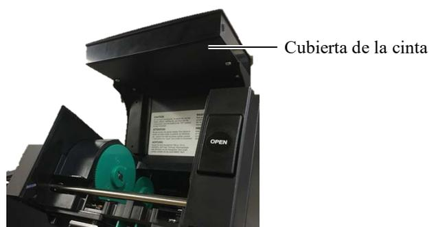
5. Ajuste el mandril de recogida de la cinta en el soporte de cinta (lado de recogida) alineando la muesca del mandril de cinta con el saliente del tope de la cinta.
