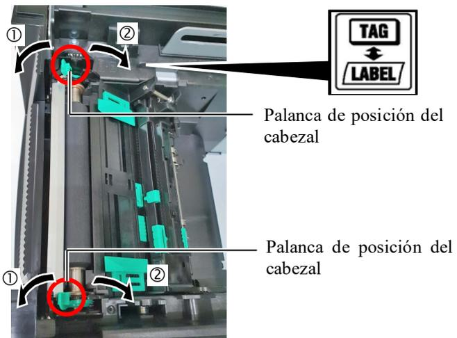
Palanca de posición del cabezal
