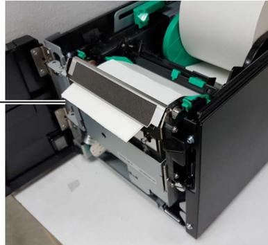
13. Cambie la presión del cabezal de impresión según el grosor del papel que vaya a utilizar usando la palanca de posición del cabezal.
