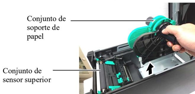
3. Levante la palanca de liberación y retire el soporte de papel (izq.).
