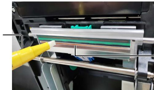
Elemento del cabezal de impresión
