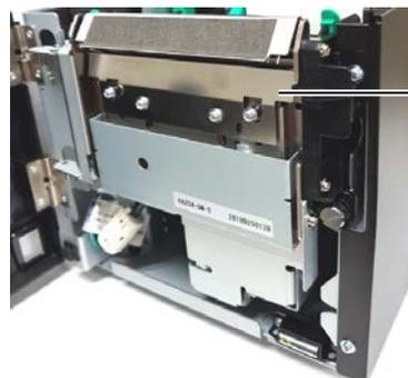
Exterior de la cuchilla del cortador
