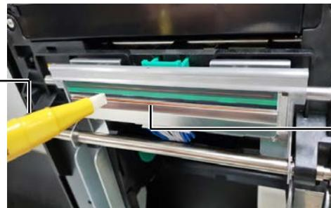
Elemento del cabezal de impresión
