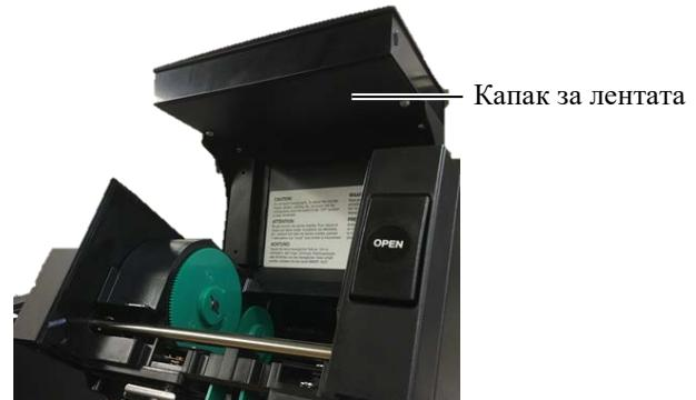
5. Поставете вътрешната част на ролката за поемане на лента в държача за лента (страница за поемане), като подравните вдълбнатината на вътрешната част на лентата с издадената част на спирация механизъм за лентата.
