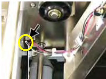
碳带终端探测器配线
