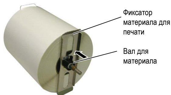
5. Закрепите фиксатор для материала на валу, повернув ручку рычага на фиксаторе в положение «Close» (Закрыто).
