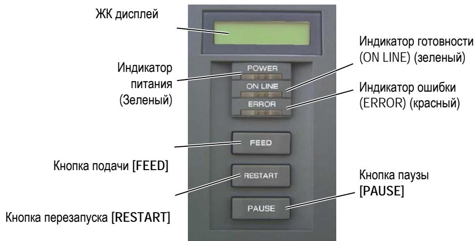
На ЖК дисплее отображаются сообщения, состоящие из цифр и букв, показывающие текущее состояние принтера. На дисплее может разместиться до 32 символов, расположенных в две строки.
