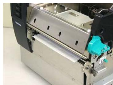
12. Сдвиньте направляющие материалов для печати внутрь, автоматически отцентрировав материал для печати. Затем затяните винты, зафиксировав при этом на месте направляющие для печати.
