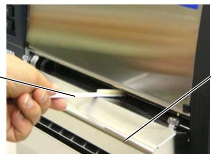
Очиститель печатной головки (поставляется в комплекте с модулем обрезки)
