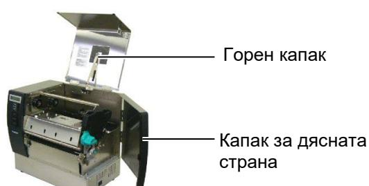
8. Отворете пластиината за заключване на главата (①) и завъртете лоста на ролката за захващане в посока обратна на часовниковата стрелка (②), за да освободите ролката за захващане.
