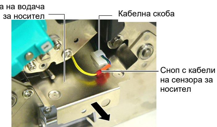
7. Втората кабелна скоба е закрепена към центъра на пластината на водача за носител. Освободете снопа с кабели на сензора за носител от кабелната скоба и издърпайте пластината на водача за носител.
