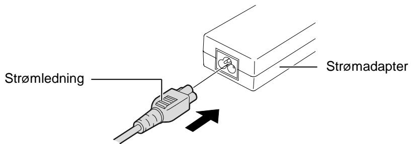
3. Sett kontakten til strømadapteren i strømkontakten på baksiden av skriveren.
