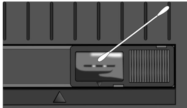
Tørk av glassplaterullen med en myk klut fuktet med (ren) etylalkohol.
