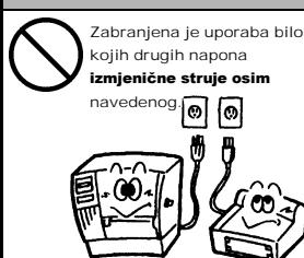
Ne primjenjujte napone osim onoga izmjenične struje navedenoga na pločici s podacima jer biste time mogli izazvati **požar ili strujni udar**.
