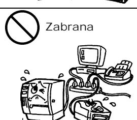
Ako je uređaj uključen u istu električnu utičnicu s drugim uređajima koji troše velike količine energije, doći će do velikih fluktuacija napona prilikom rada uređaja. Svakako osigurajte zasebnu utičnicu za uređaj jer biste mogli izazvati **požar ili strujni udar**.
