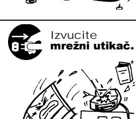
Ako ispuštite uređaj ili oštetite kućište, najprije isključite prekidače napajanja i izvucite utikač iz mrežne utičnice, a zatim zatražite pomoć ovlaštenog predstavnika tvrtke TOSHIBA TEC CORPORATION. Ako nastavite koristiti proizvod u takvom stanju, to može izazvati **požar ili strujni udar**.
