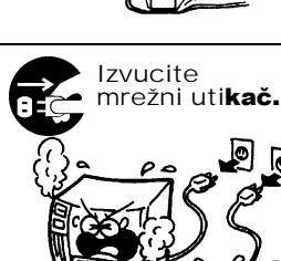
Ako se nastavite koristiti uređajem u nepravilnom stanju, primjerice kada iz uređaja izlazi dim ili čudan miris, mogli biste izazvati **požar ili strujni udar**. U tom slučaju odmah isključite prekidač napajanja i iskopčajte kabel za napajanje iz utičnice. Zatim zatražite pomoć ovlaštenog predstavnika tvrtke TOSHIBA TEC CORPORATION.
