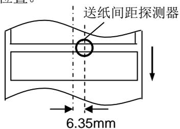
3. 黑标探测器可在打印介质的宽度范围内移动。
