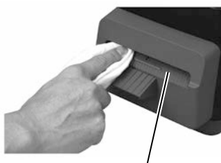
Έξοδος μονάδας κοπής
