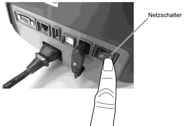
2. Nach dem Einschalten des Druckers leuchten LED 1 und 2 zuerst orange, gehen dann aus und schließlich leuchtet LED 1 grün.
