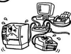
Falls die Maschinen dieselbe Stromquelle mit irgendwelchen anderen Elektrogeräten teilen, die einen hohen Stromverbrauch haben, kann es zu Spannungsschwankungen kommen, wenn diese Geräte in Betrieb genommen werden. Schließen Sie die Maschinen unbedingt an, da es unter Umständen zu einem **Kurzschluss** oder **Überlastungen** führen kann, die dann einen Brand auslösen können.
