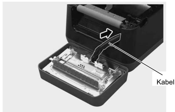
11. Setzen Sie den Schneideblock vorne am Drucker ein. Kontrollieren Sie, dass die beiden unteren und die beiden oberen Haken in die Schlitz mit den Pfeilmarkierungen einrasten. Montieren Sie nach dem Einsetzen des Schneideblocks die Schneideablage.
