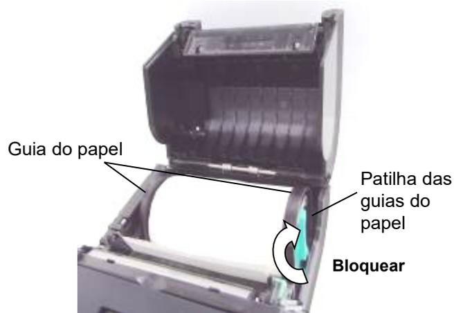
6. Puxe a extremidade superior do consumível na direção do Painel de operação e feche a Tampa superior, retirando a folga do consumível.
