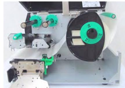
8. 将介质置于导纸夹之间，调整导纸夹至介质宽度，待位置正确后拧紧固定螺丝。
