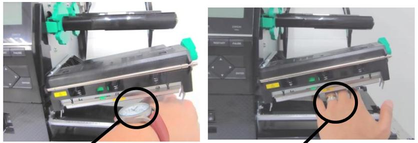
Debe tenerse cuidado para que ni la esfera ni la parte metálica del reloj toquen el borde del cabezal de impresión.
