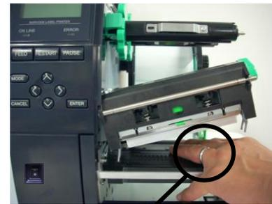
Необходимо соблюдать осторожность, чтобы не допускать возможного контакта между металлическими объектами, таких как кольца, и поверхностью печатающей головки.
