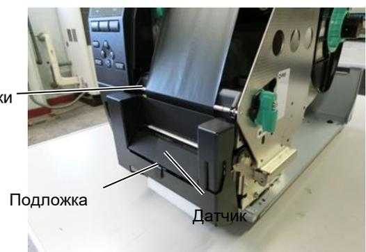
5. Вручную переместите датчик отслаивания таким образом, чтобы он оказался по центру этикеток, выходящих из выходного отверстия. (Как правило, датчик выравнивается по центру выходного отверстия)
