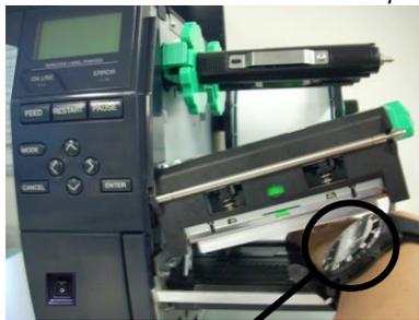
Необходимо соблюдать осторожность, чтобы не допускать возможного контакта между металлическими или стеклянными элементами часов и с поверхностью печатающей головки.
