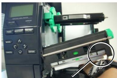
Необходимо соблюдать осторожность, чтобы не допускать возможного контакта между металлическими или стеклянными элементами часов и поверхностью печатающей головки.
