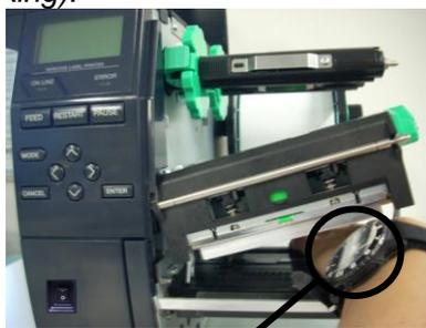
Achtung: Das Metall eines Ringes oder einer Armbanduhr kann die Druckkopfkante beschädigen.
