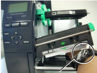
Achtung: Das Metall eines Ringes oder einer Armbanduhr kann die Druckkopfkante beschädigen.
