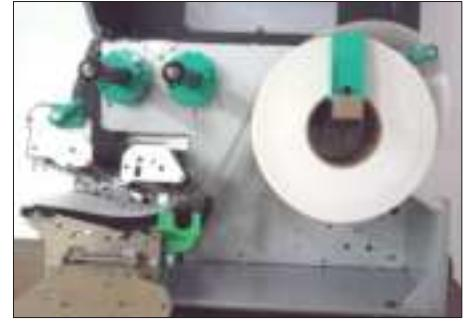
8. 将介质放在导纸夹之间，再根据介质宽度调整导纸夹的宽度，并锁紧固定螺丝。
