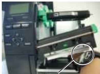
**注意不要让金属或手表表面的玻璃部分接触打印头边缘。**
