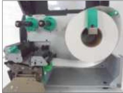
标签纸打印面朝外安装方法
