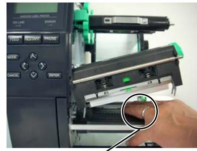
Необходимо соблюдать осторожность, чтобы не допускать возможного контакта между металлическими предметами (часами или кольцами) и поверхностью термоголовки.
