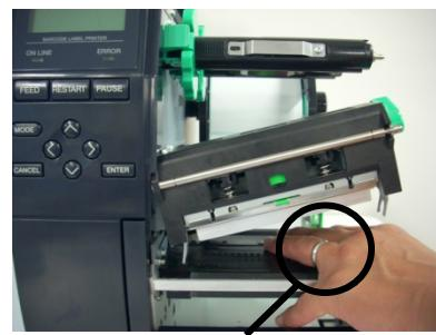
Необходимо соблюдать осторожность, чтобы не допускать касаний металлическими предметами (кольцами) поверхности термоголовки.
