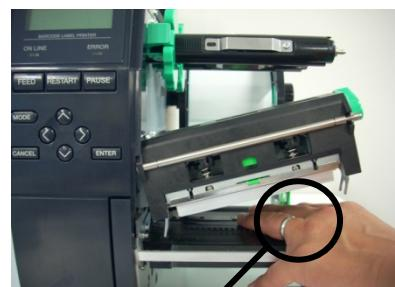
Необходимо соблюдать осторожность, чтобы не допускать касаний металлическими предметами (кольцами) поверхности термоголовки.
