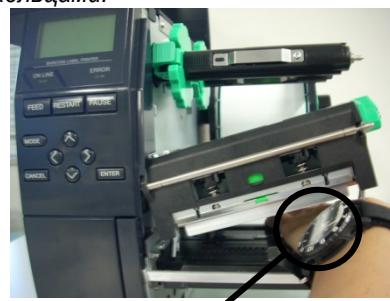
Необходимо соблюдать осторожность, чтобы не допускать касаний металлическими или стеклянными частями часов поверхности термоголовки.
