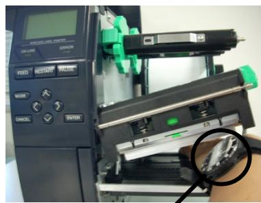
Pripazite da metalnim ili staklenim dijelom sata ne dodirnete rub glave za ispis.
