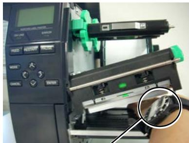
Pripazite da metalnim ili staklenim dijelom sata ne dodirnete rub glave za ispis.
