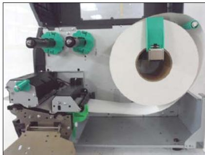
Para rollos de etiquetas con el área de impresión en el exterior.
