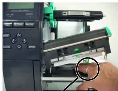
Debe tenerse cuidado para que ningún objeto metálico como un anillo toque el borde del cabezal de impresión.
