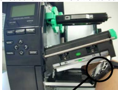
Debe tenerse cuidado para que ni la esfera ni la parte metálica del reloj toquen el borde del cabezal de impresión.
