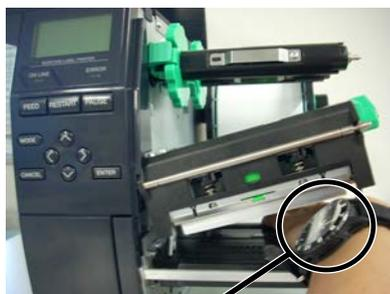
Debe tenerse cuidado para que ni la esfera ni la parte metálica del reloj toquen el borde del cabezal de impresión.
