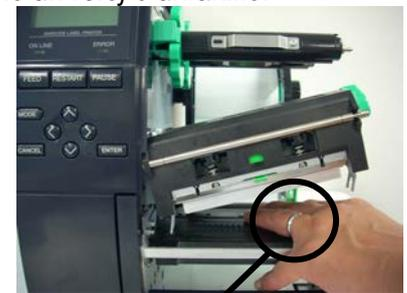
Debe tenerse cuidado para que ningún objeto metálico como un anillo toque el borde del cabezal de impresión.
