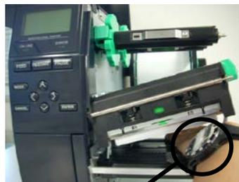
Achtung: Das Glas oder Metall einer Uhr kann die Druckkopfkante beschädigen.
