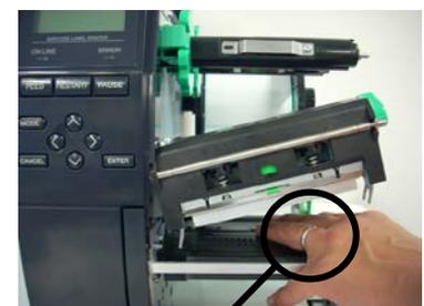
Achtung: Das Metall eines Ringes kann die Druckkopfkante beschädigen.
