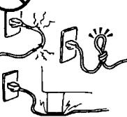
請勿刻割、損壞或修改電源線。請勿將重物放在電源線上、拽拉電源線或使電源線過度彎曲，否則可能導致火災或觸電。
