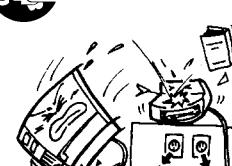
如果機器掉落或機殼損壞，請關閉電源開關並將電源線插頭從插座斷開，然後聯繫授權的東芝泰格代理尋求協助。繼續使用損壞的機器可能導致火災或觸電。
