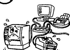
如果機器與其他耗電量大的設備共用相同的插座，則每次操作這些設備時，電壓均將大幅波動。請務必為機器提供專用插座，否則可能導致火災或觸電。
