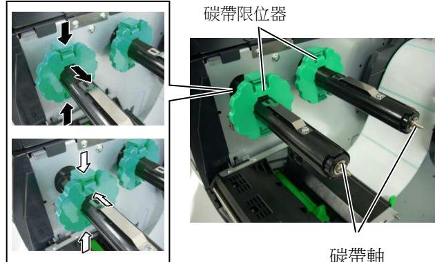
2. 如下圖所示，在碳帶軸之間留出足夠的空隙，把碳帶放到碳帶軸上。
