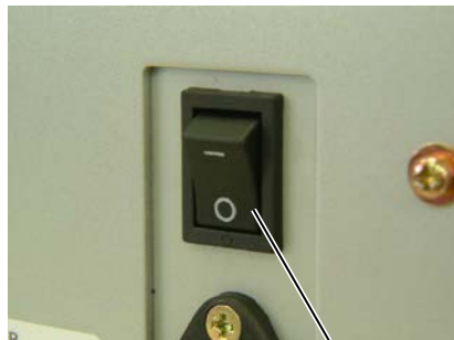
Interruptor de energia
