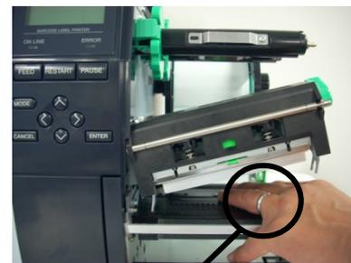
Не трябва да позволявате метален предмет, като например пръстен, да докосва края на печатащата глава.
