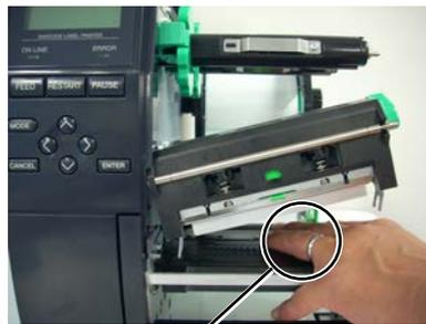
Не трябва да позволявате метален предмет, като например пръстен, да докосва края на печатащата глава.
