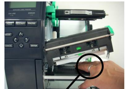
Не трябва да позволявате метален предмет, като например пръстен, да докосва края на печатащата глава.
